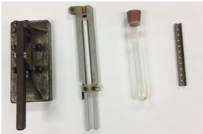
Fig 2: Composants et outils utilisés pour les essais (de g à d : gabarit d'encoche, outil de pliage et de transfert, tube à essai, bande de maintien)
