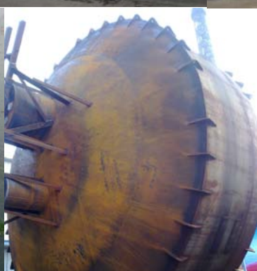
Réacteur en acier de chemise D 10m x H 6M étant moulé sur rotation site l'épaisseur de la paroi en acier 14-16mm, tôle d'acier pèse 42,670 kg, PE épaisseur de chemise 18mm, poids d'injection 5,800kg
